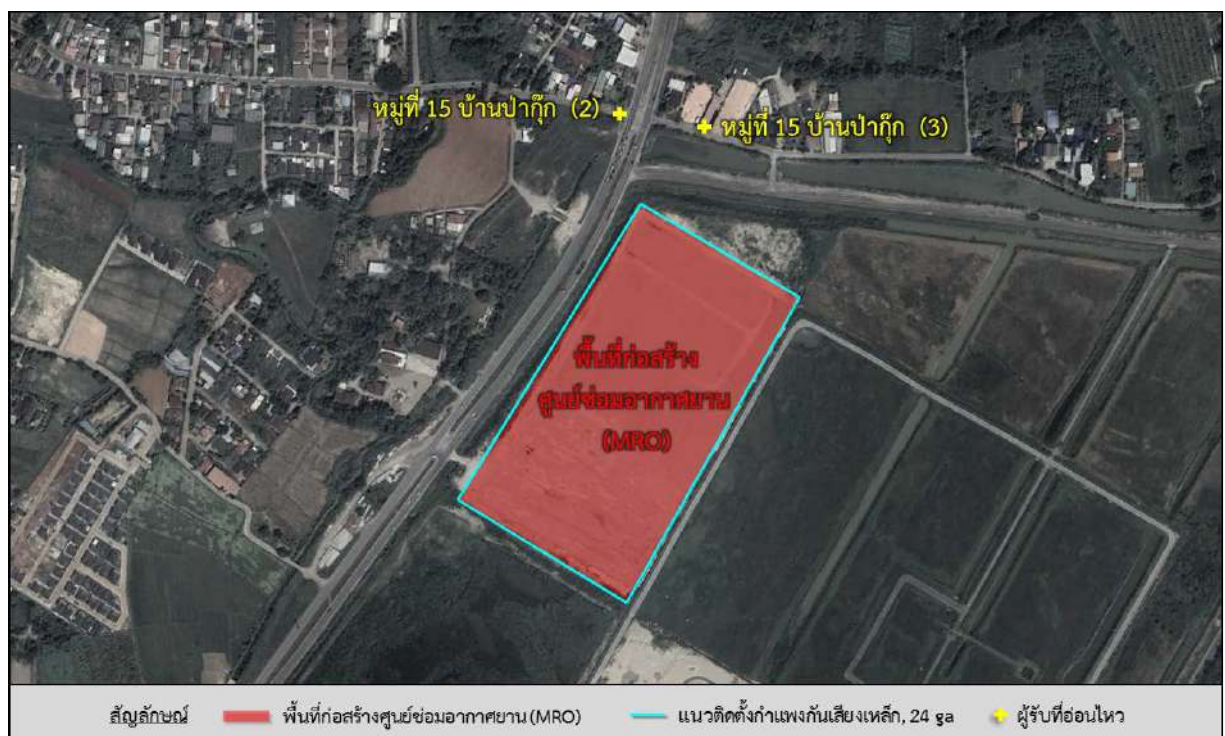
รูปที่ 4.2.5-5 ตำแหน่งติดตั้งกำแพงกันเสียงชั่วคราวในช่วงก่อสร้าง << กลับหน้าสารบัญรูป
