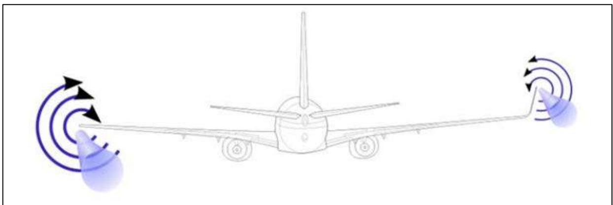
รูปที่ 4.2.6-1 ภาพแสดงกระแสการไหลวนของอากาศที่ปลายปีก (Wingtip vortices) ระหว่างปลายปีกเครื่องบินที่มีและไม่มี Winglet
